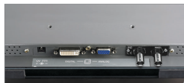
Zapętlone złącze BNC do łączenia wielu paneli
